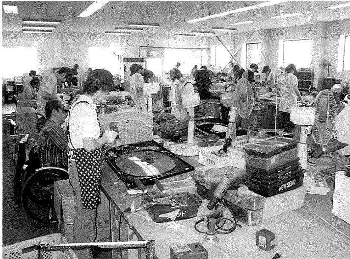
使用済み遊技機は手作業で丁寧に分別される。また、障害者や高齢者の雇用、自立支援の役割も担っている。写真は、アキラ産業の作業現場。
